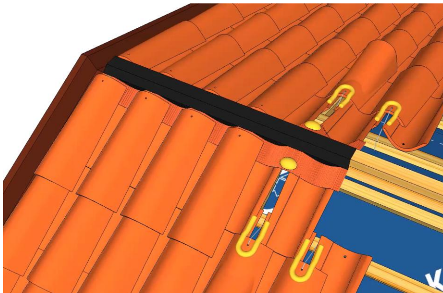
Figura 13: Posizionamento dei coppi superiori
