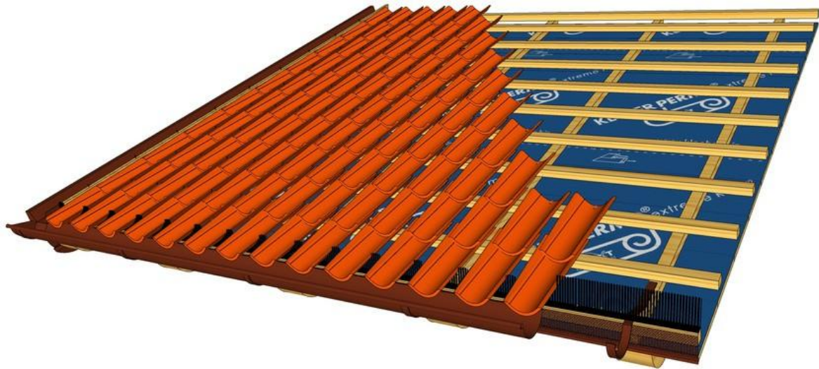
Figura 5: Posa dei coppi inferiori usando coppo rigato
