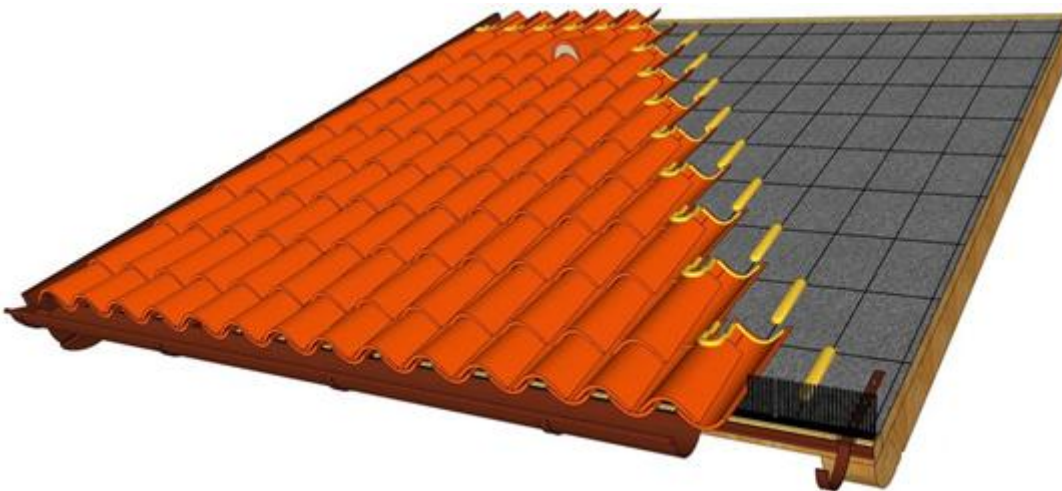
Figura 2: Posa dei coppi superiori usando coppo liscio e inferiori usando coppo liscio o rigato
